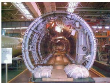
航空機用ワイヤーハーネス (中胴部ワイヤーハーネス組付作業)
