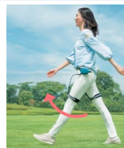
バネと振り子の動きで、脚の振り出しをアシストします
