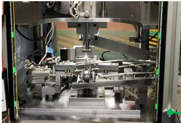
からくり技術を用いた 内製のブラケット自動組立設備
