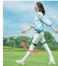
aLQ：バネと振り子の動きで、脚の振り出しをアシストします
