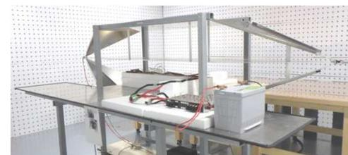
新たに導入した電磁環境両立性評価（EMC評価）設備
