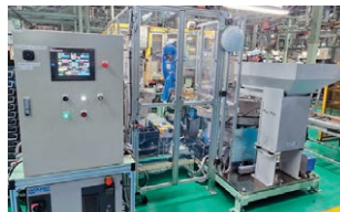
(岡山工場) 自動部品セットロボット バラ積み部品無人セットロボット
